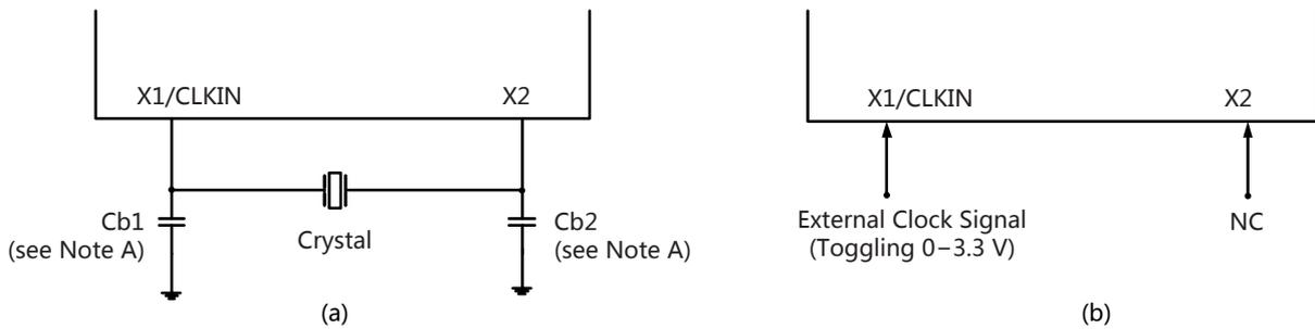
图 3-6-2 推荐的晶体/时钟连接
