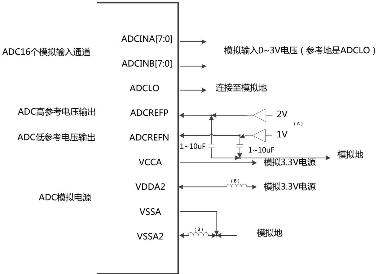
图 3-2-2-4 外部基准的 ADC 引脚连线
