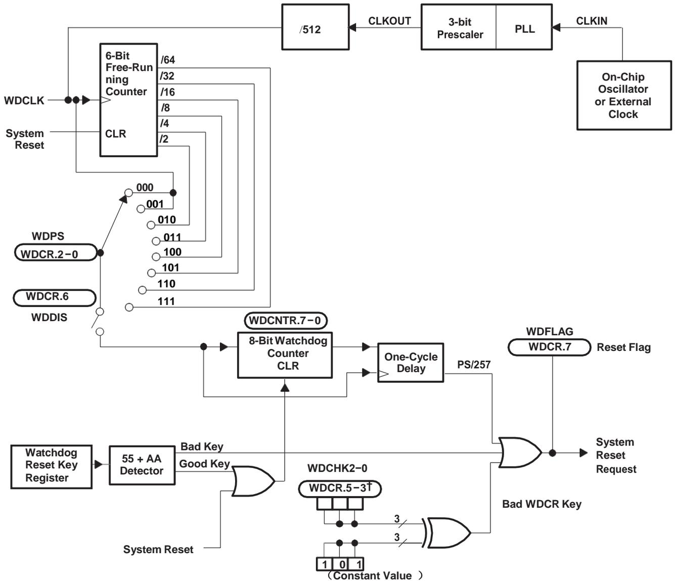
图 3-8 WD 模块的工作原理方框图
