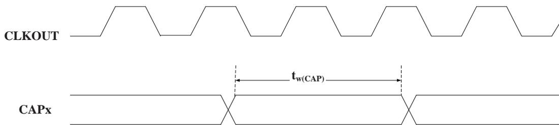
图 5-16-2.捕捉单元输入和 QEP 时序
