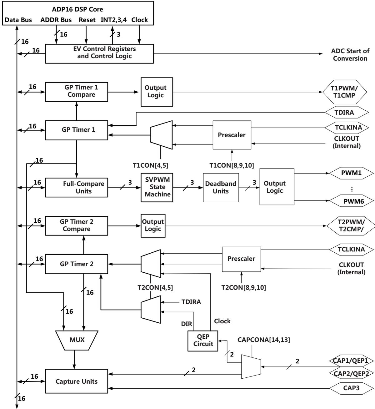
图 3-1-1 事件管理器 EM1 功能方框图(EM1 和 EM2 相同)
