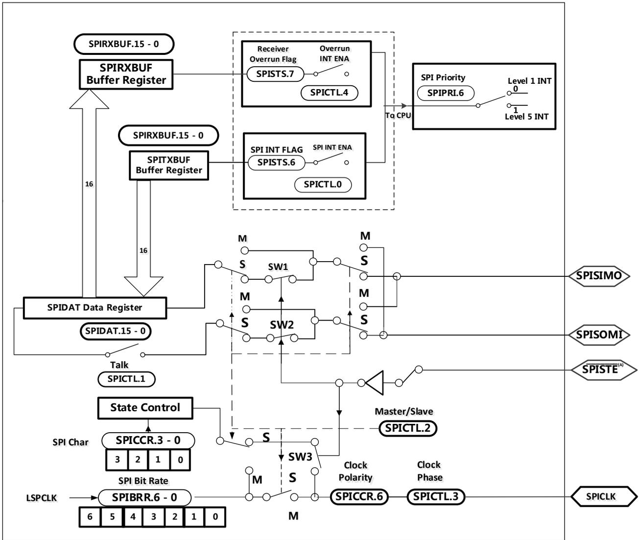
图 3-5 SPI 从模式的工作原理方框图
