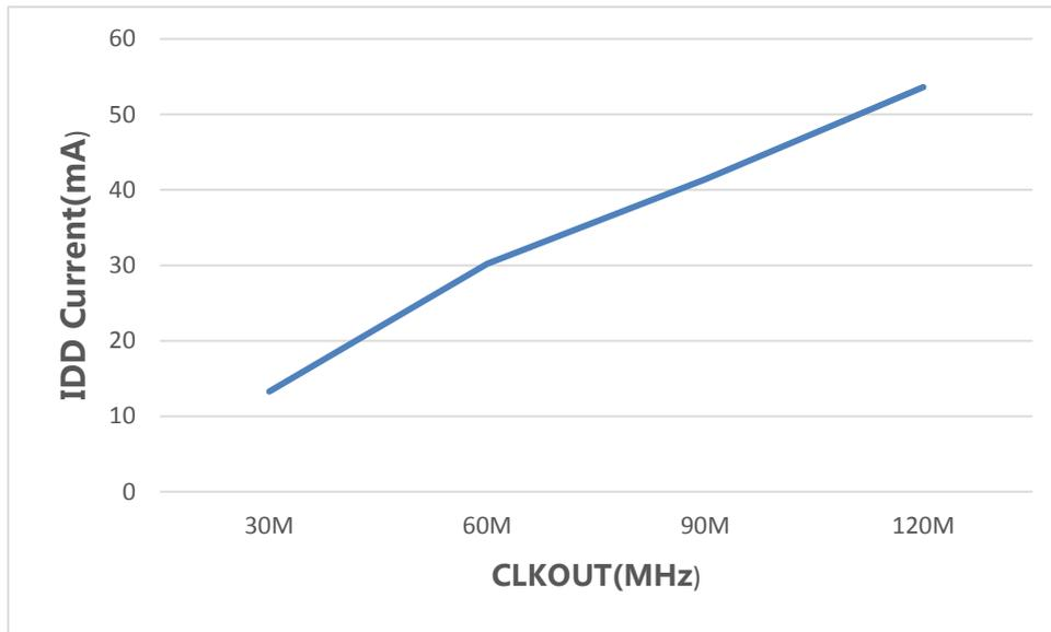
图 5-1.ADP16C09 在频率范围内的典型电流消耗（使能外设时钟）
