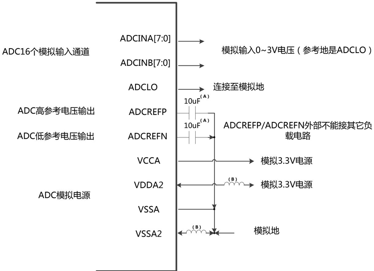
图 3-2-2-2 ADC 引脚内部基准的连线
