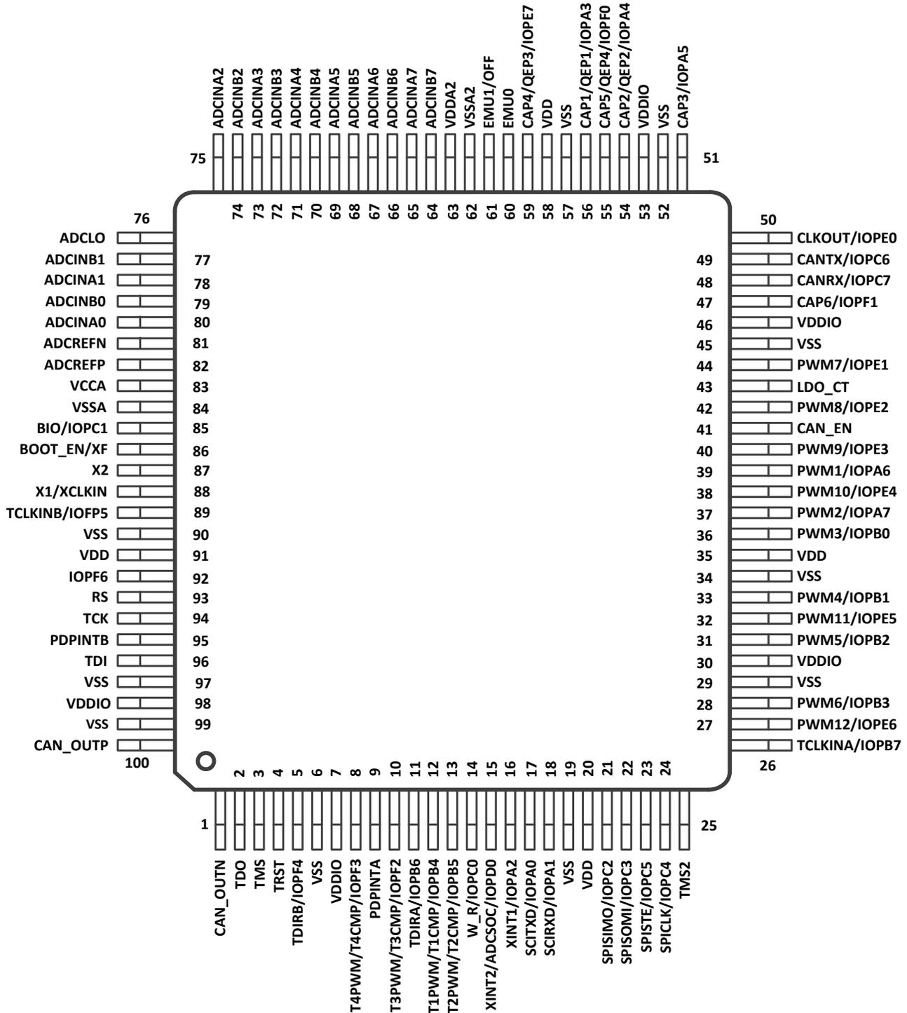
图 1-2.封装引脚图(顶视图)
