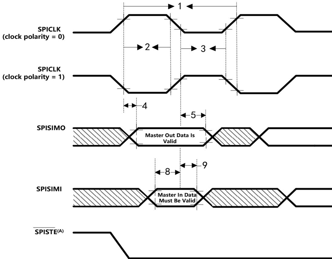
A. 在 主控模式下，在有效的 SPI 时钟边沿之前  $0.5t_c(\text{SPC})$ ， $\overline{\text{SPISTE}}$  变为有效。在字的尾端， $\overline{\text{SPISTE}}$  在接收到最后一个数据位的边沿 (SPICLK) 之后  $0.5t_c(\text{SPC})$  将变为无效，除非  $\overline{\text{SPISTE}}$  在 FIFO 和非 FIFO 模式中的背靠背传送字间保持有效。
