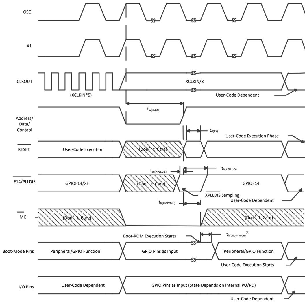
A. 复位后，引导ROM 代码执行用于  $1260 \text{ SYSCLKOUT}$  周期 ( $\text{SYSCLKOUT} = \text{OSC}/2$ ) 的指令，然后采样BOOT 模式引脚。基于引导模式引脚的状态，引导代码向目的内存或者引导代码函数下达分支指令。为了适当的选择引导模式，BOOT 模式引脚应该从引导ROM 执行时间开始后至少  $2520 \text{ OSC}$  周期内保持高电平/低电平。如果引导ROM 代码在加电条件后（在调试器环境中）执行代码，引导代码执行时间由当前的  $\text{SYSCLKOUT}$  的速度而定。  $\text{SYSCLKOUT}$  将基于用户环境并可在PLL 启用或者不启用时使用。
