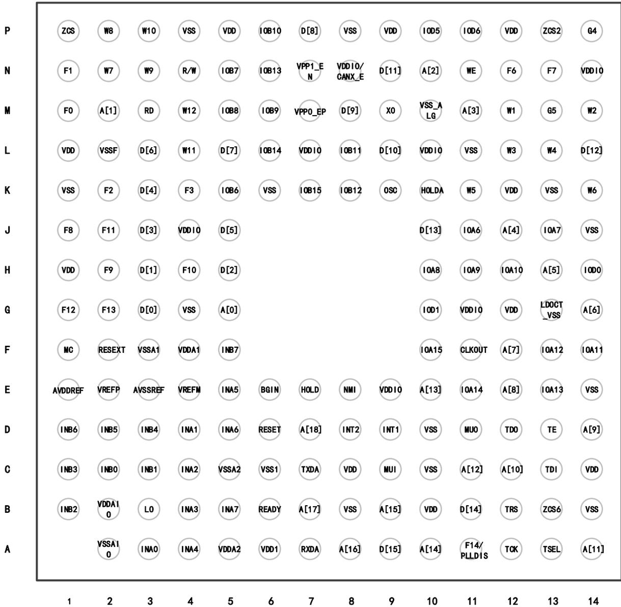
图 1.2-1 封装引脚分布图 (底视图)
