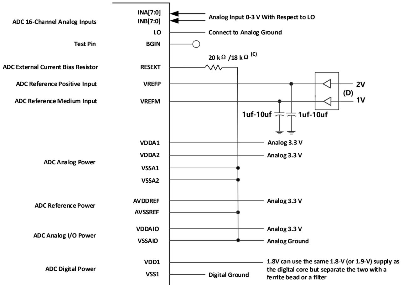
图3.3-3. 与外部基准的ADC 引脚连接
