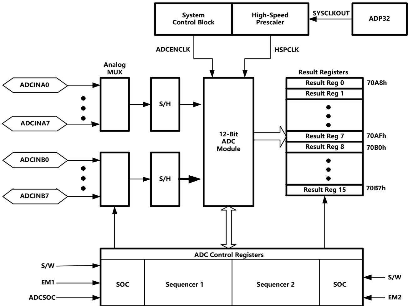
图3.3-1. ADP32FXX ADC 模块方框图
