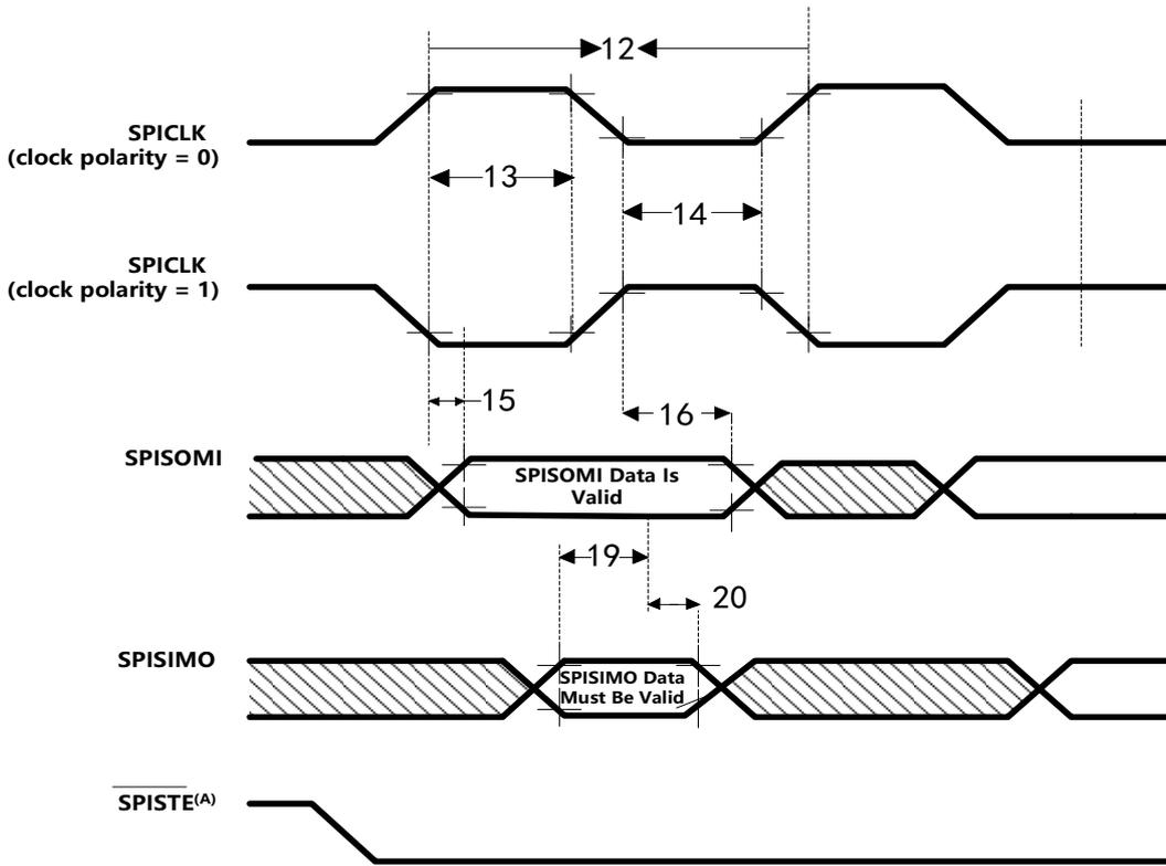
图5-28. SPI 受控模式外部时序 (时钟相位= 0)
