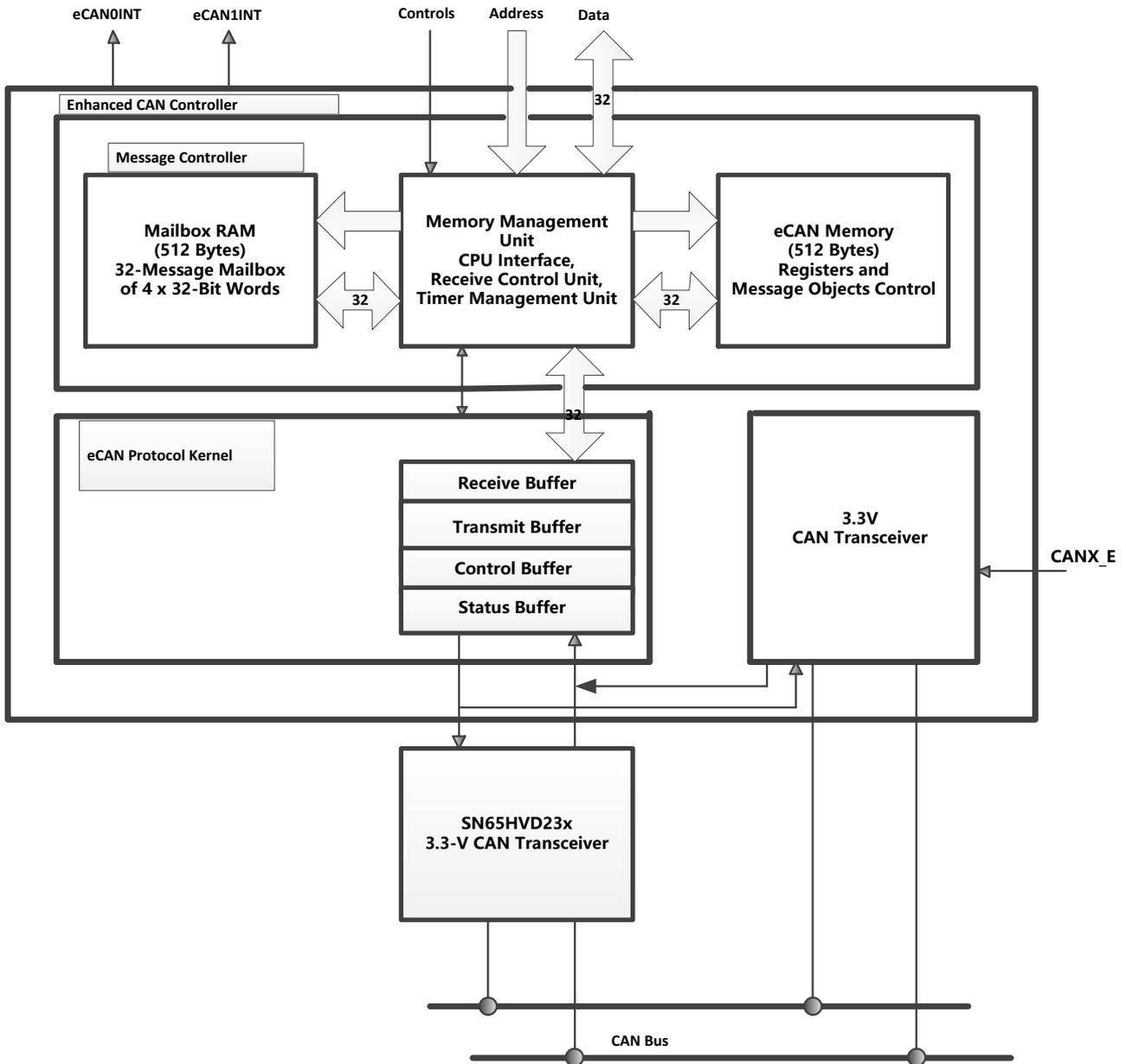
图 3.4-1. eCAN 方框图和接口电路
