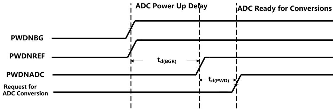
图 5-40. ADC 加电控制位时序
