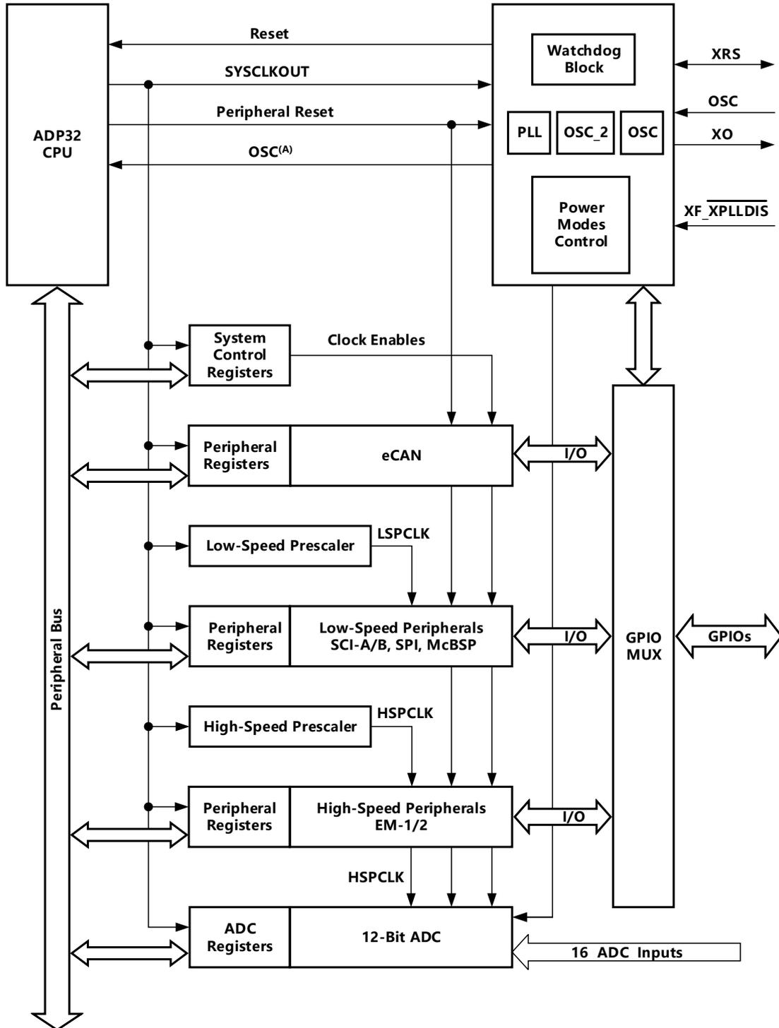
A. CLKIN 是到 CPU 的时钟输入。SYSCLKOUT 是 CPU 的输出时钟。它们的频率相同
