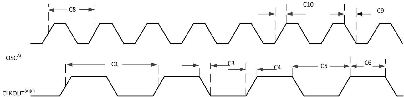
A. OSC与CLKOUT 的关系取决于所选择的分频因子。图5-10中显示的波形关系只用于解释时序参数并且根据实际配置会有所不同。
