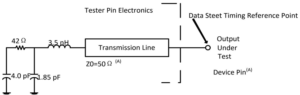
A. 此数据表在器件引脚上提供时序。对于输出时序分析，必须将测试器引脚电子特性和其传输线路效应考虑在内。带有2ns或者更长时间延迟的传输线路可被用于生成所需的传输线路效应。传输线路只用于一个负载。无需从数据表时序中增加或者减少传输线路延迟（2ns或者更长）。
