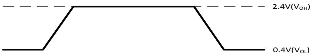
图 5-7. 输出电平
