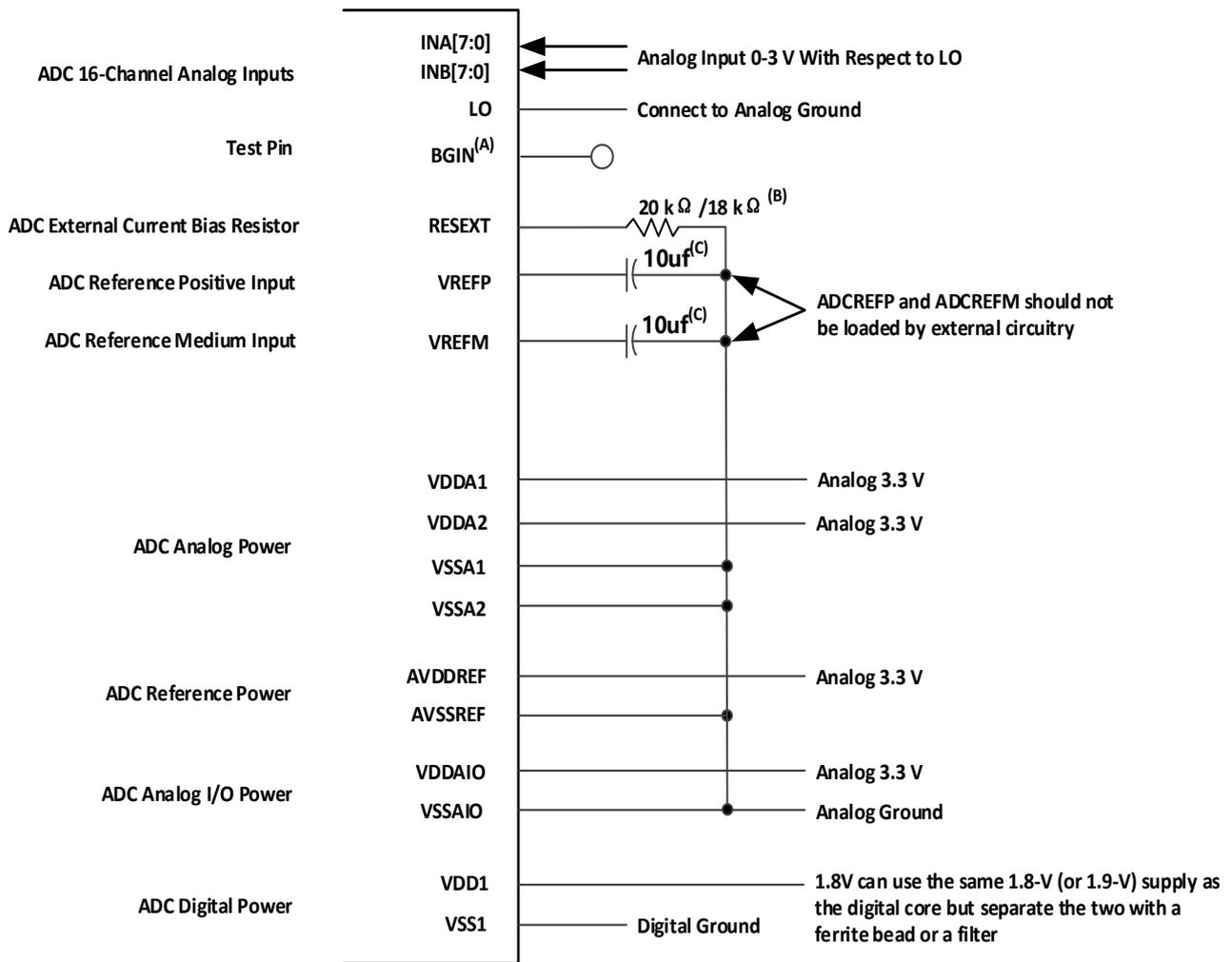
图3.3-2. 与内部基准的ADC 引脚连接
