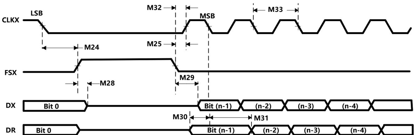
**图 5-45. 作为 SPI 主控或者受控时的 McBSP 时序: CLKSTP=10b, CLKXP=0**
