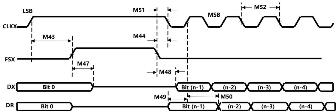
**图5-47. 作为SPI 主控或者受控时的McBSP 时序: CLKSTP= 10b, CLKXP= 1**
