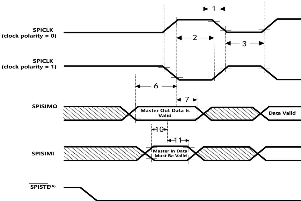
**图 5-27. SPI 主控外部时序 (时钟相位= 1)**
