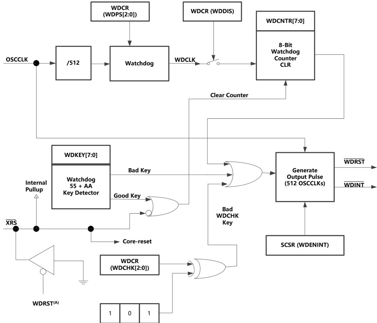
A.  $\overline{WDRST}$ 信号在 512 个 OSCCLK 周期内被驱动为低电平。
