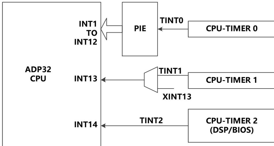
图 3-2. CPU 定时器中断信号与输出信号
