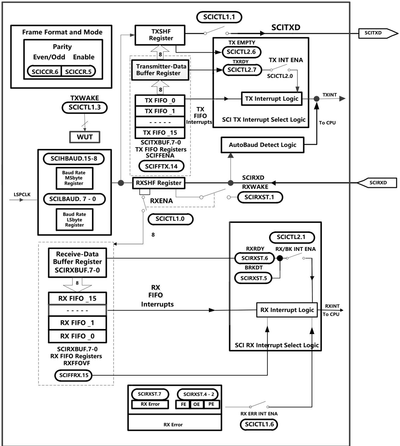
图3-6. 串行通信接口(SCI) 模块方框图
