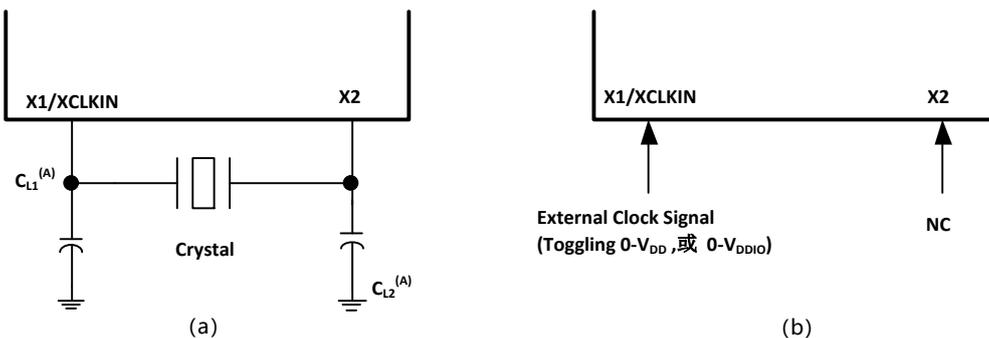
图 2.9 推荐的晶振/时钟连接
