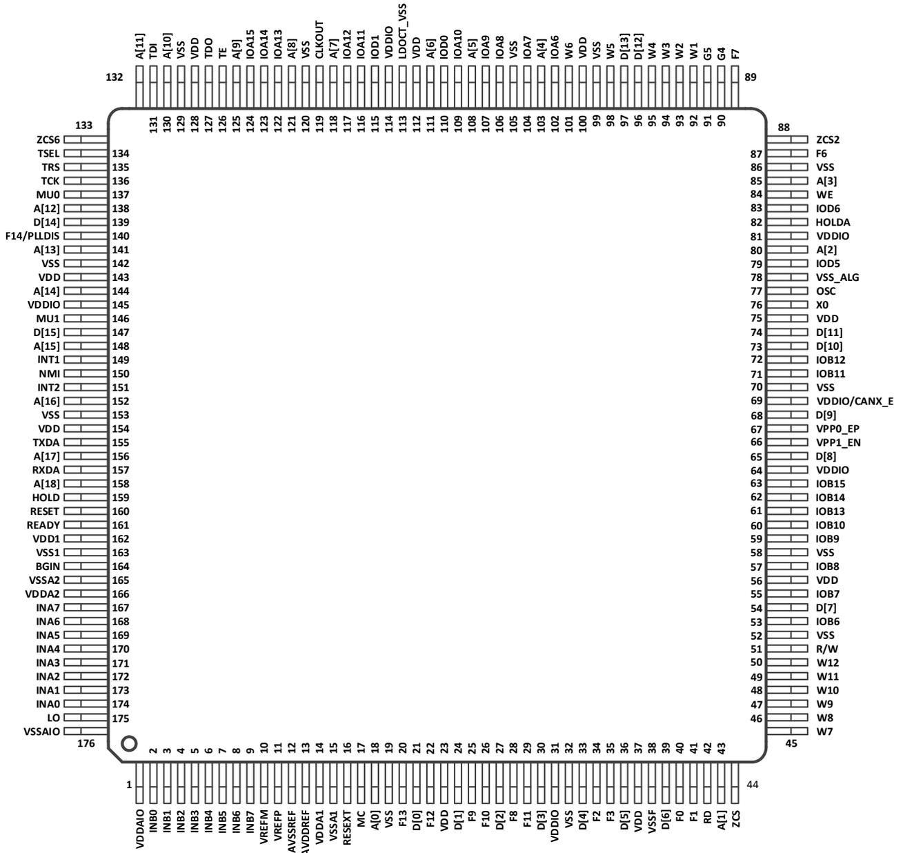
图 1.2-2 封装引脚图(顶视图)
