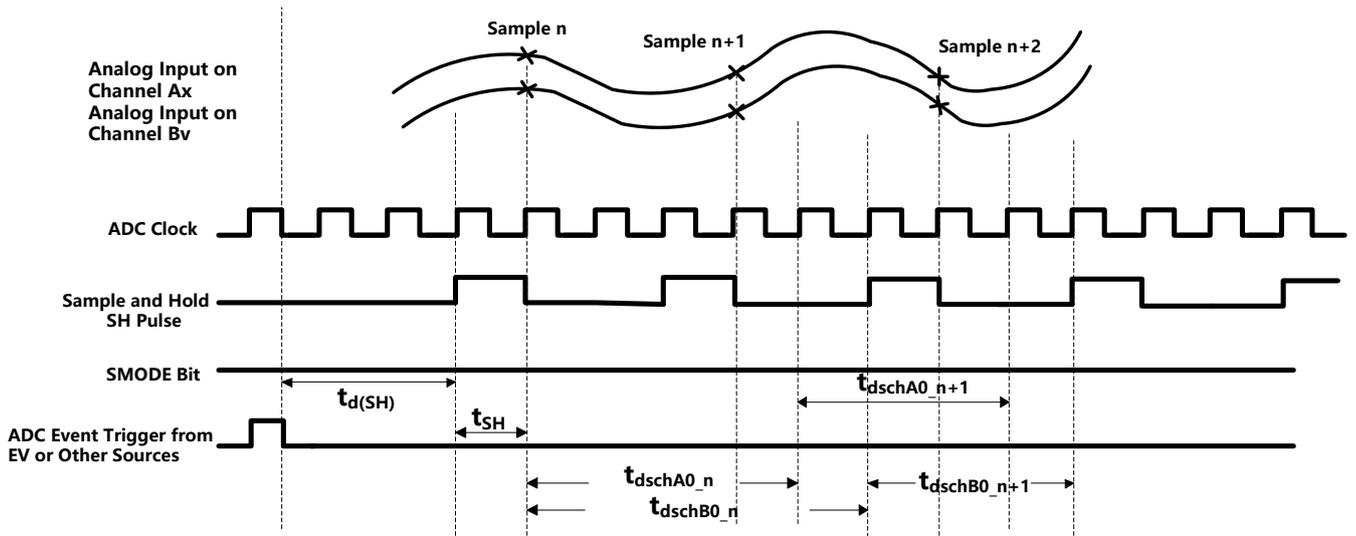
图5-42. 同步采样模式时序
