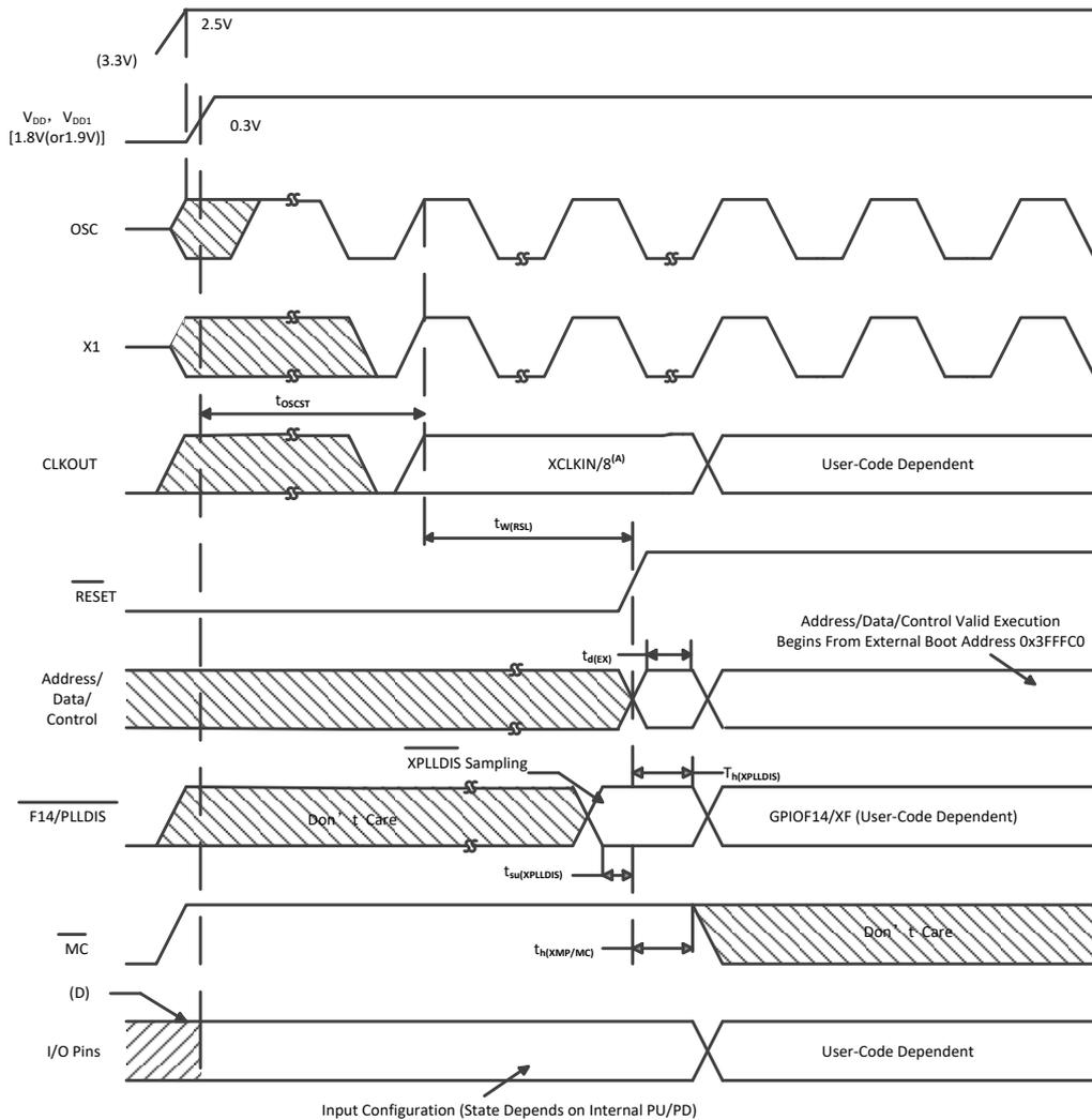
A. 加电时，如果PLL 被启用，SYSCLKOUT 为OSC/2。由于XINTCNF2 寄存器内的XTIMCLK 和CLKMODE 位出现时的状态为复位状态1，SYSCLKOUT 在它出现在CLKOUT 上之前被进一步4分频。这就解释了在这个阶段CLKOUT=OSC/8 的原因。
