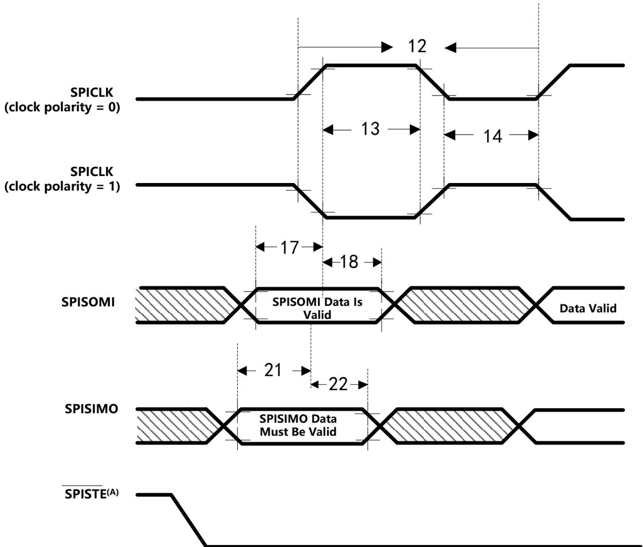
图5-29. SPI 受控模式外部时序 (时钟相位= 1)
